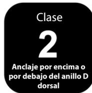
*Busque el icono de clase 2 para determinar si se puede utilizar un SRL para el anclaje situado por debajo del anillo D dorsal (es decir, para atarse a la altura de los pies).*
